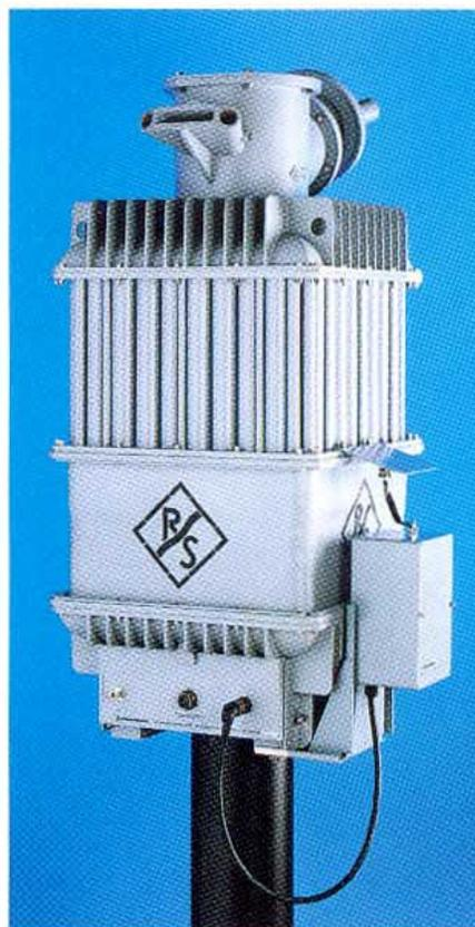
HF-Dipol HX002 (ohne Dipolstäbe) mit montierter Frequenzbereichserweiterung HX002F
